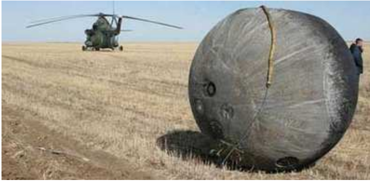
Der Hitzeschild der "Foton M3"-Kapsel nach dem Aufschlag in Kasachstan | Copyright: ESA
